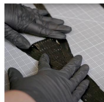
La technologie composite Intelliweave de College Park est un processus breveté développé pour assurer un maximum de solidité et de flexibilité au pied prothétique. Contrairement au processus standard de superposition 2D en fibre de carbone, Intelliweave permet d'obtenir des modèles illimités tissés en 3D et une parfaite adaptation entre les zones où la résistance est requise et celles où, au contraire, la flexibilité s'impose.
